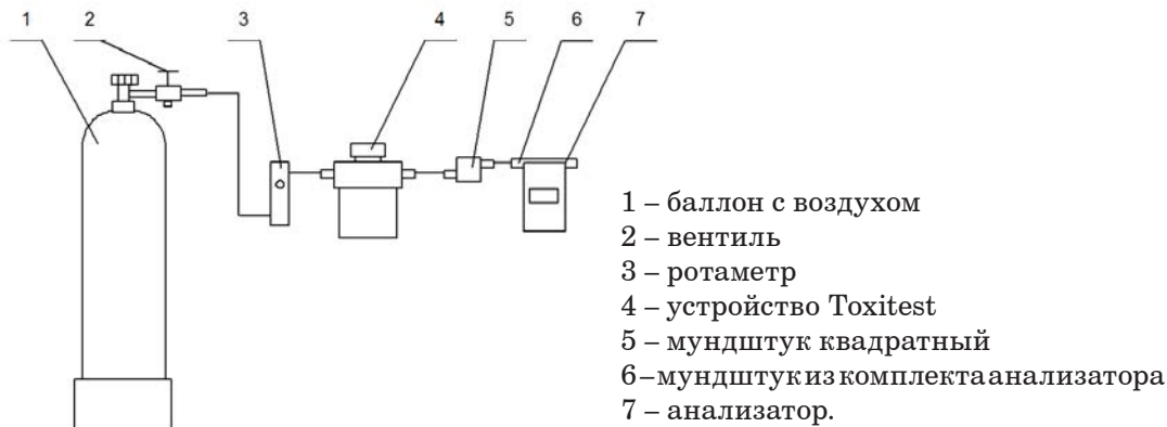
Рисунок 2 – Схема газовой системы при подаче на анализаторы ГС от устройства Toxitest
