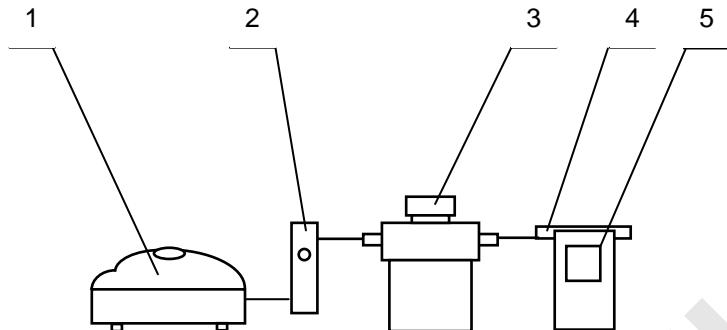
1 – компрессор; 2 – ротаметр; 3 – генератор ГС;
