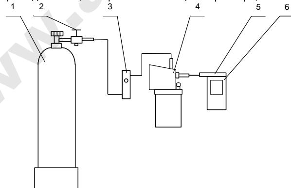
1 – баллон с воздухом; 2 – вентиль; 3 – ротаметр; 4 – генератор;
