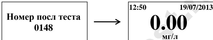
*Примечание – Если результат последнего измерения не был определен, на дисплее отобразится сообщение «NC», а в распечатанном протоколе измерения (при подключенном внешнем принтере) будет отсутствовать строка с режимом отбора пробы, при этом вместо результата измерения будет выведена надпись «Результат: Попыток выдоха [0]».*
