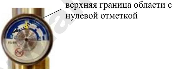
Рисунок 19 – Манометр на редукторе баллона
