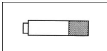
1) Если на дисплей выводится предупреждение о низком напряжении питания в виде мигающего сообщения в сопровождении коротких звуковых сигналов, это означает, что уровень напряжения батарей питания, установленных в отсеке питания, низкий, но его достаточно для проведения еще нескольких измерений. В этом случае рекомендуется как можно скорее заменить батареи питания в отсеке питания.
