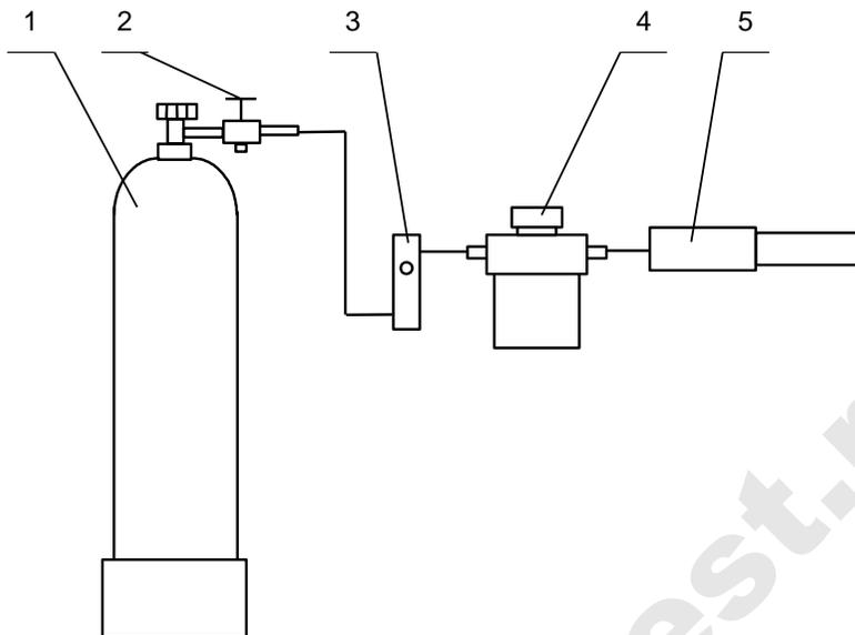
1 – баллон с воздухом; 2 – вентиль; 3 – ротаметр; 4 – генератор; 5 – сигнализатор
