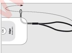
Чтобы исключить риск случайного падения анализатора, можно прикрепить ремешок на руку и при эксплуатации одевать его на запястье:
