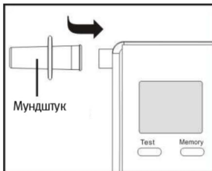
Нажмите и удерживайте кнопку **Тест** (Test) до включения. Раздастся звуковой сигнал, на дисплее высветится показание счетчика тестов, после чего пойдет обратный отсчет до нуля. В течение этого времени происходит самотестирование прибора и разогрев датчика. На дисплее высвечивается надпись **WAIT** (Ждите). По завершении отсчета прозвучит звуковой сигнал готовности к продуванию.
